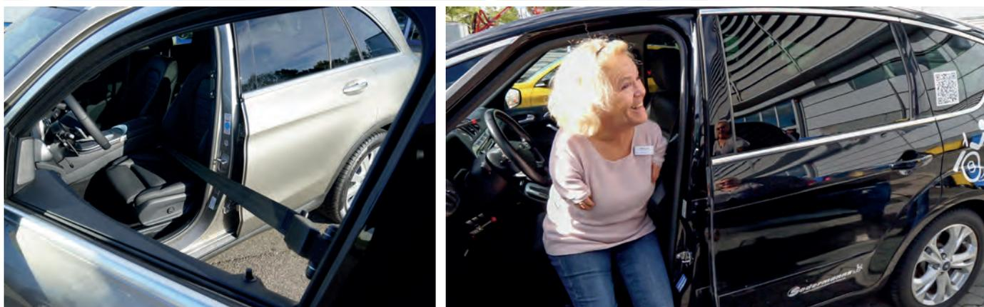
Der „Postgurt“ ermöglicht das automatische Anschlallen mittels Schulter-Schräggurt, wenn das Handling eines serienmäßigen Gurtes nicht möglich ist.
