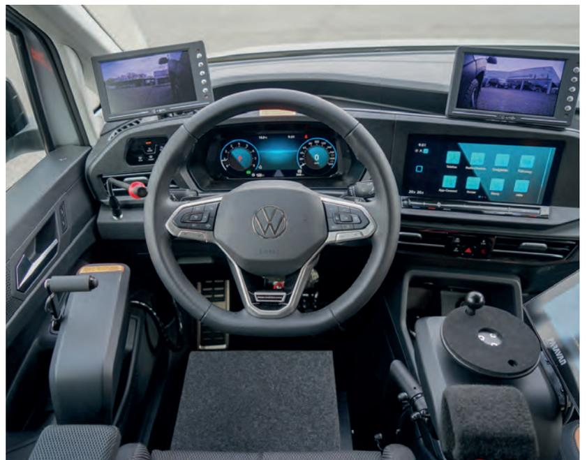
Digitales Lenk- und Bremssystem (Gas-Brems-Schieber, Mini-Lenkrad), Sprachsteuerung für Sekundärfunktionen wie Blinker, Hupe, Licht etc., Kamerasystem bei eingeschränktem Schulterblick, spezieller Fahrersitz mit 6-Wege-Funktion uvm.
